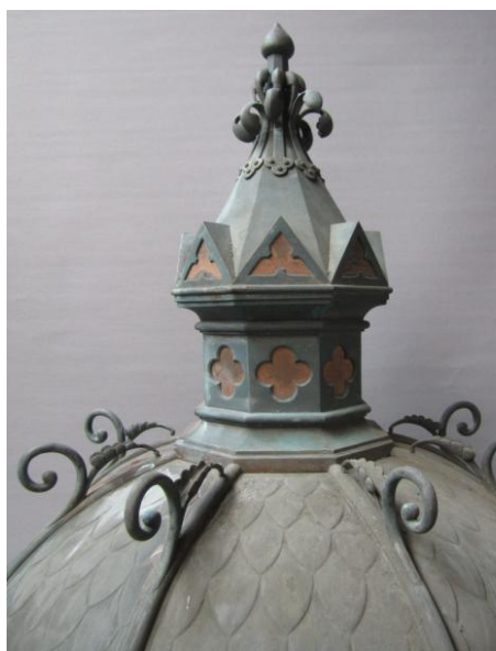
Groene corrosie op volledige oppervlak
